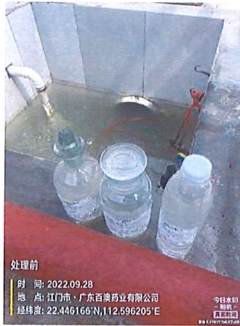
图 1: 化粪池+一体化污水处理设施处理前水样
