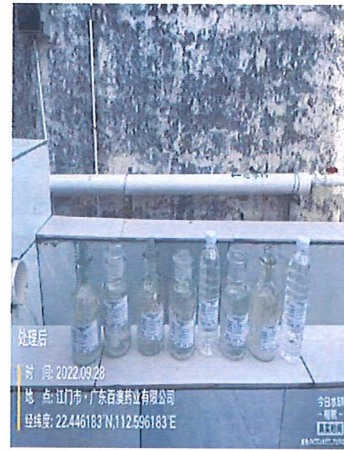
图 2: 化粪池+一体化污水处理设施处理后水样
